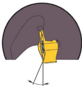
Положительный осевой угол на малых глубинах обеспечивает мягкое резание
